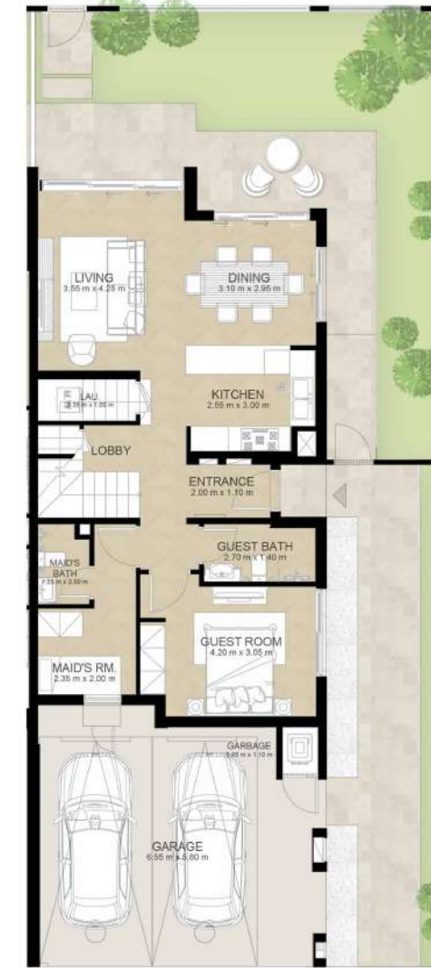
GROUND LEVEL الطابق الأرضي
